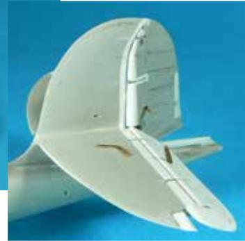
autocostruiti e resi mobili creando delle vere e proprie cerniere in alluminio, vincolate all'interno del flap da un tondino di acciaio passante e con le estremità sporgenti fissate saldamente nell'ala, lo stesso lavoro l'ho realizzato per i piani di coda e la deriva.
