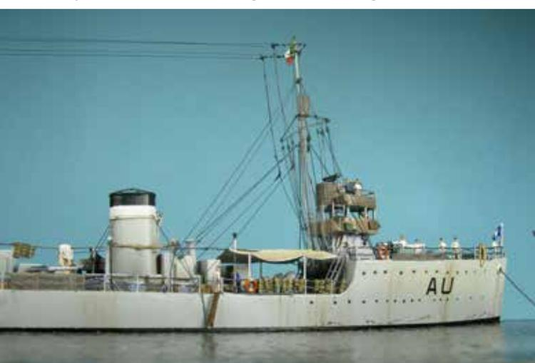
e le antenne filari della radio sono tutte in sprue stirato a caldo, gli isolatori sono goccioline di vinavil.
