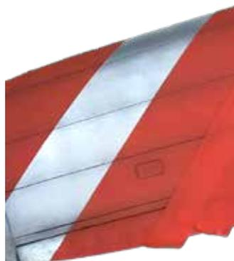
l'avvistamento in caso di ammaraggio forzato. Il tricolore, che ho verniciato ad aerografo, era dipinto sia sulla parte mobile della deriva sia sulla superfici mobili dei piani di coda. Il "lampo" lungo la fusoliera è stato ottenuto con una attenta mascheratura e verniciatura ad
