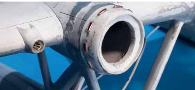
Sulla naca motore bisogna evidenziare le uscite del flusso d'aria mancanti nel kit e con paziente lavorazione ho ottenuto il particolare desiderato, ne ho evidenziato il rilievo utilizzando dei tubi in rame schiacciato ad hoc per dar loro la caratteristica forma.
