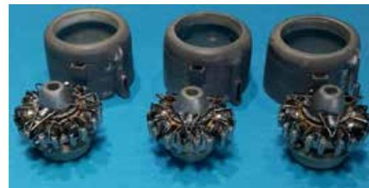
degne di migliorir. Ho sostituito con tondini di ferro lucidato dal diametro di 8/10 mm i tubi visibili nella parte anteriore del motore, rifacendo anche l'impianto elettrico delle candele, il castello di tenuta, un supporto motore costruito in tre triangoli in ferro armonico sempre da 8/10 mm. Ogni cofano motore ha ricevuto nuove prese d'aria utilizzando degli scarti di resina opportunamente scolpiti. Lo scarico
